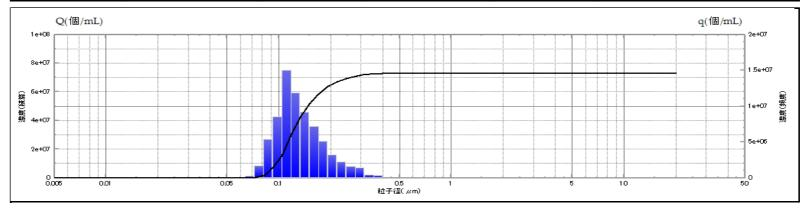
モード径 : 112nm 平均径 : 132nm
