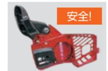
作業中キックバックが起きた際、慣性力でチェンブレーキが作動し、0.1秒でソーチェーンの回転を強制停止します。
