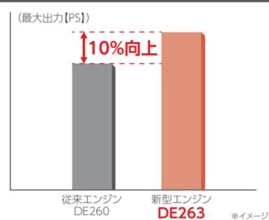
4流掃気シリンダの採用で、混合燃料の流れがスムーズになりました。少ない燃料でも燃焼しやすくなり、燃費の向上、馬力UPを実現しました。
