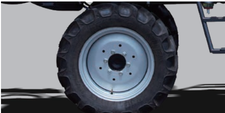
ラジアルタイヤ 幅広のラジアルタイヤを採用。踏圧を低く抑えることが可能になりました。 サイズ : 280/70R20 (外径 900mm 幅 280mm)
