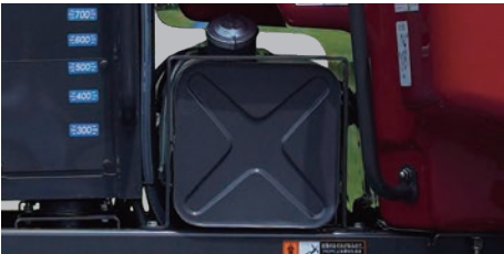
70L 燃料タンク 燃料タンクは 70L と余裕のある大容量です。給油回数も減り稼働率が向上します。
