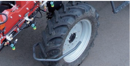
護葉板 護葉板は作物の巻き込みや、作物がタイヤで傷つくのを防ぎます。
