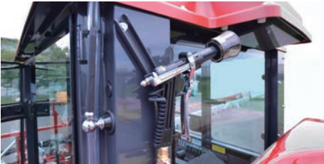
ピストルノズル 薬剤タンクのナカコシアミや薬剤のボトルなどちょっとした洗浄に重宝するピストルノズルを装備しています。
