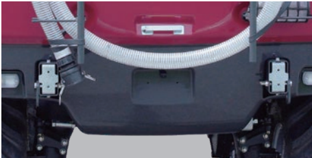
ヒッチメンバー 薬液を載せるための資材などを置くためのカゴなどを装着できるヒッチメンバーを標準装備しています。
