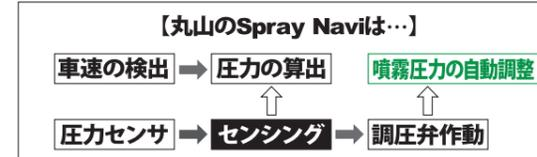
だから… ①走行速度が変動しても定量散布を行います。 ②スライドによる散布幅の変化、また片側ブーム散布を停止しても定量散布を行い精密防除が可能です。
