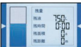
**■タンク残量** 薬液残量に応じた残液量、残時間、残面積を自動計算し表示します。
