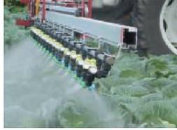
\*生研センターと参画メーカーによる次世代農業機械等緊急開発事業での共同開発品空気混入タイプのノズルで従来のノズルに比べドリフトしやすい微細粒子を大幅に低減し付着性を向上させるため2層の扇形噴霧にしています。
