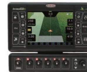
殆どのISOノズルに対応し、GPS(散布)ガイダンスでセクションコントロールが可能になりました。セクションコントロールにより重複散布を抑制します。
