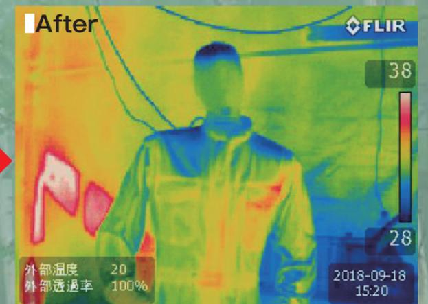
※約 30cm<sup>2</sup>の室内にマネキンを置き、ミスト噴霧、サーモグラフィーによる温度変化を計測。
