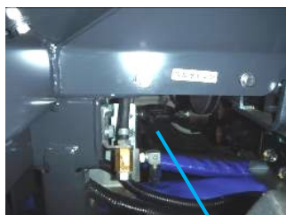
冷却水ドレン
