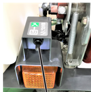
給水ポンプスイッチ
