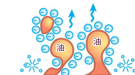
泡の破裂を繰り返すことによる剥離作用で、油汚れを落とす。
