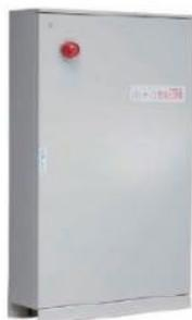
※パッケージ型消火設備 I 型とは、消防法令の規定により、地階を除く6階以下で延べ面積3,000㎡以下の建物に設置される屋内消火栓代替の消防用設備です。駐車場や倉庫を除く建物に設置されています。
