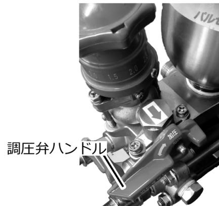
④ 圧力調整二ギリを回して、所要の圧力に設定します。
