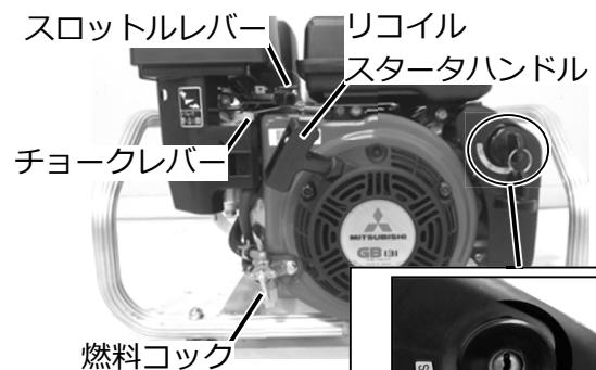
⑥ 標準付属品のキースイッチをエンジンスイッチ鍵穴に差込み、「ON」の位置にしてください。
