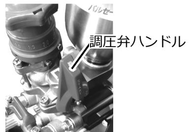
③ 圧力調整ニギリを回して「0」位置にしてください。
