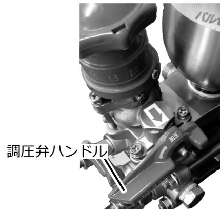
④ 圧力調整ニギリを回して、所要の圧力に設定します。
