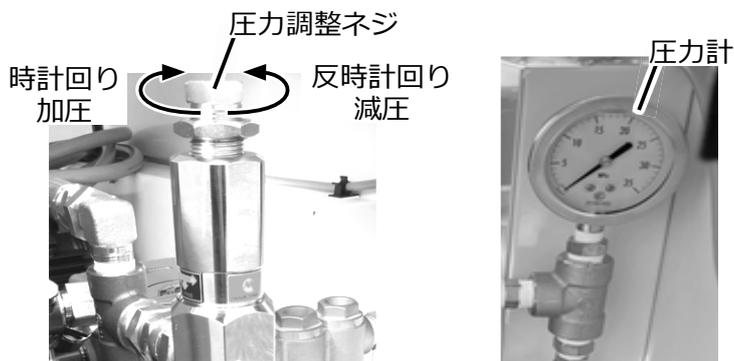
ノズルからの噴射を停止している状態で、圧力値の調整を行ってください。
