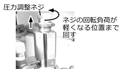
④ 最低圧力の位置まで圧力調整ネジを回してください。(24 ページの「5) 圧力の調節」参照。)
