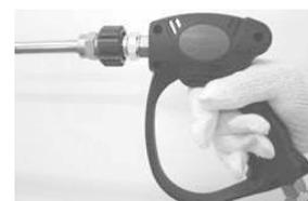
④ ガンレバーのロックを解除してガンレバーを握り、ノズル先からエア抜きを行ってください。30 秒程度でエア抜きが完了します。
