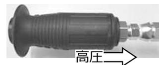
② ノズルを使用条件に合わせ、直噴 (右回し)、拡散 (左回し) にしてください。
