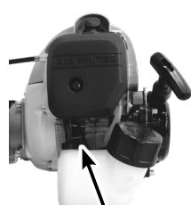
冷却風取出口 (格子部)
