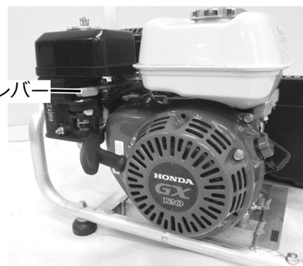
③ 圧力調整二ギリを回して、所要の圧力に設定します。
