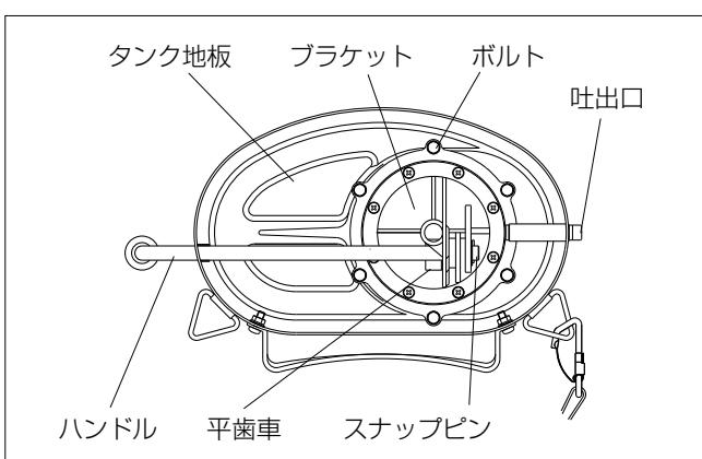
工場出荷時は、標準の体位に合わせてありますが、ハンドル位置を変えたい時には、薬剤タンクの下のブラケット部にあるスナップピンを抜き取り、平歯車の噛合いをずらし適宜のハンドル位置に調整してください。調整後スナップピンを戻します。
