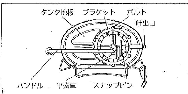
工場出荷時は、標準の体位に合わせてありますが、ハンドル位置を変えたい時には、スナップピンを抜き取り、平歯車の噛合をずらし適宣のハンドル位置に調整してください。
