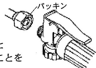
⚠️※作業前に接続部のパッキンに脱落のないこと、各ネジ部にゆるみがないことを確認してください。
