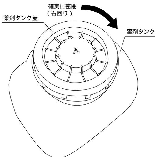
薬剤タンク蓋パッキンを確かめ確実に右に回して密閉します。
