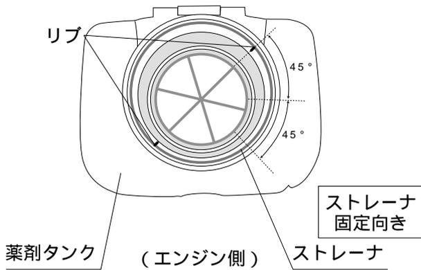
ストレーナの内側の両サイドのリップを水平若しくは垂直の状態ですて薬剤タンクに設置し、その位置から45°回転させると、ストレーナを薬剤タンクに半固定できます。発泡系の薬剤使用のとき、ストレーナの浮き上がりを防止することができます。
