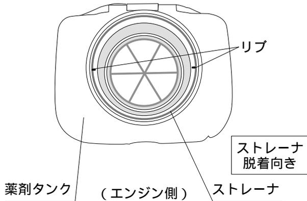
ストレーナの内側の両サイドのリップを薬剤タンクと水平若しくは垂直にすると、ストレーナの脱着ができます。
