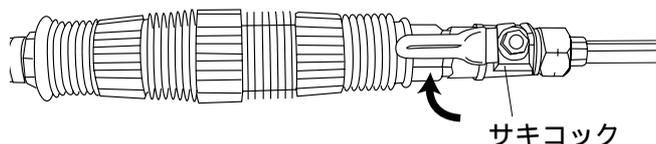
噴霧されない場合は、サキコックを閉じた状態で一度ノズルを取り外し、サキコックを開きポンプ内のエアを抜いてから、再度ノズルを取り付けてください。
