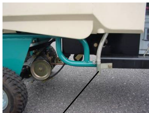
動噴オイルドレンプラグ
