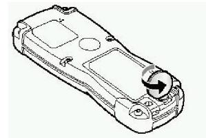
② 送信機の電池フタのネジを、コインなどで回してゆるめてください。
