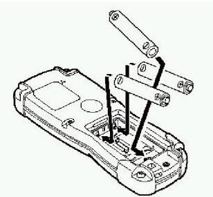
④ 電池ボックス内の表示に従い、電池の極性(+, -)に注意して電池を
