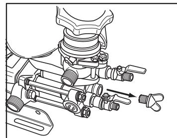
② 凍結破損防止のために水抜きを十分に行い、配管の一端を外し、コックを開けてください。
