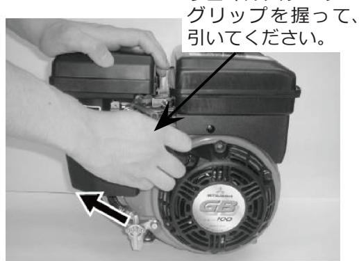
⑩ エンジンが始動したら、チョークレバーを徐々に「開」の方に移動させ、最後は全開にしてください。
