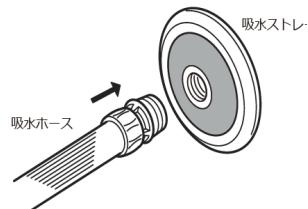
② 吸水ホースの先端に、吸水ストレーナを取り付けてください。
