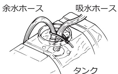
⑤ 余水ホースは、薬剤タンクから飛び出さないように、付属のバンドで吸水ホースに固定してください。
