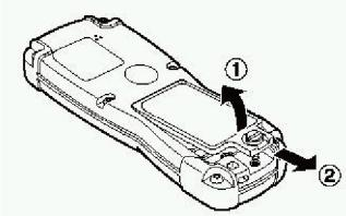
③ 電池フタのネジ側を持ち上げ、下側に引くようにして本体から、
