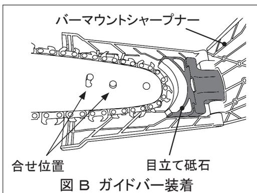
ガイドバー先端の穴をバーマウントシャープナーの2本のピンに合わせてください。（図B）
