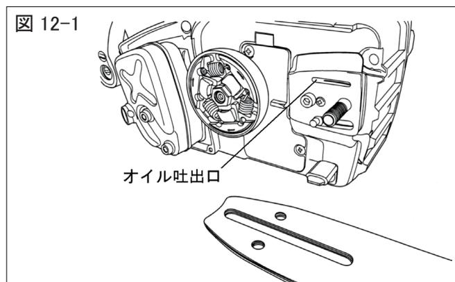
チェンオイルの供給不良を防ぐため、1日の作業が終わった後にガイドバーとソーチェーンを取外して、チェンオイル吐出口周辺に付着しているゴミとガイドバー溝の底にたまったゴミを、鉄板等で取除いてください。
