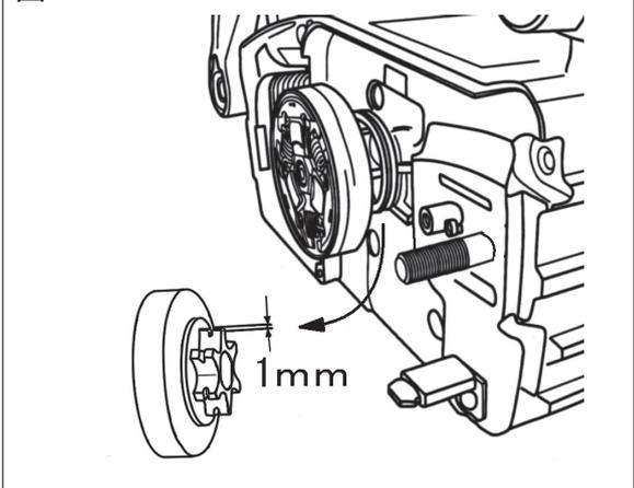
①ガイドバーを取外した時に、クラッチドラム内側のソーチェーン駆動スプロケットを点検してください。
