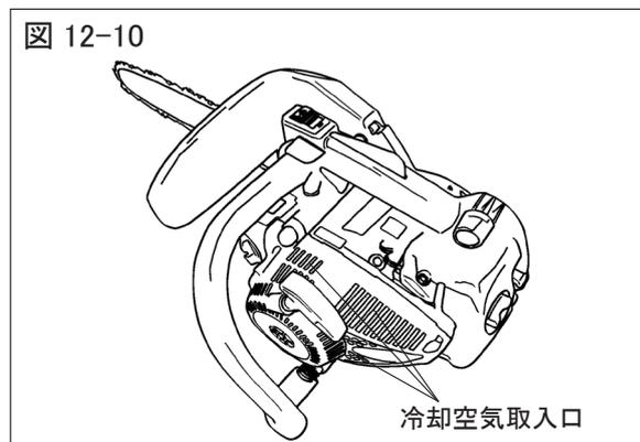
このエンジンは強制空冷式です。冷却用の空気取入口やシリンダフィンの上にゴミが詰まると冷却不良によりエンジンが過熱し、故障の原因となります。時々点検し、ゴミを取除いてください。
