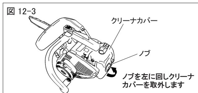
①機体後方のノブを左に回してゆるめ、クリーナカバーを後方に引いて取外してください。
