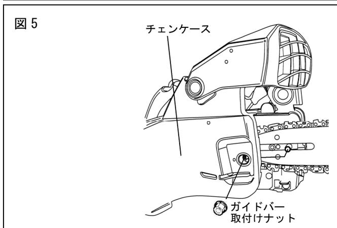
②ガイドバー取付けナットを外して、チェーンケースを外します。
