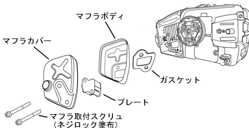
マフラ内部にカーボンが堆積すると出力低下や始動不良を起こします。使用100時間毎を目安に、マフラ内部を点検清掃してください。
