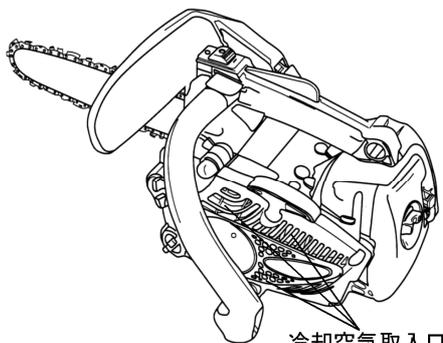
このエンジンは強制空冷式です。冷却用の空気取入口やシリンダフィン間にゴミが詰まるとエンジンの冷却不良が発生し、エンジンが過熱し、故障の原因となります。時々点検し、ゴミを取り除いてください。
