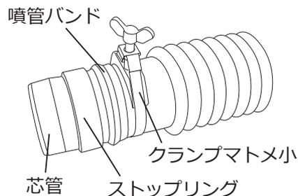
③ 芯管とストップリングの間にホース噴頭を通してください。ストップリングで、ホースが抜けないようにしっかりと固定してください。
