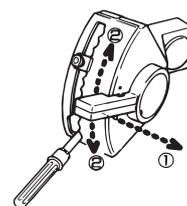
④ シャッタレバーを上げて散布してください。シャッタレバーを軽く内側にひきながら操作してください。
