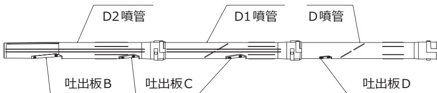
D2噴管とD1噴管、D1噴管とD噴管の接続方法は、D噴管と自在管の接続方法と異なります。下記の方法でD2噴管とD1噴管、D1噴管とD噴管の接続を行ってください。
