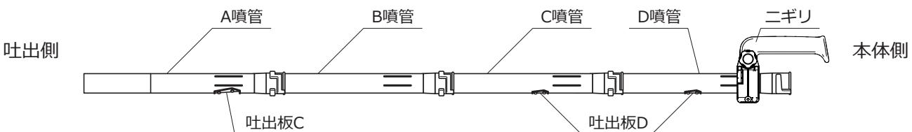
A噴管とB噴管、B噴管とC噴管、C噴管とD噴管の接続方法は、D噴管と自在管の接続方法と異なります。下記の方法でA噴管とB噴管、B噴管とC噴管、C噴管とD噴管の接続を行ってください。
