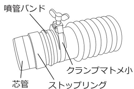
③ 芯管とストッピングの間にホース噴頭を通してください。ストッピングで、ホースが抜けないようにしっかりと固定してください。
