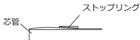
② 蛇管に芯管を差し込み、クランプマトメ小で組み付けてください。
