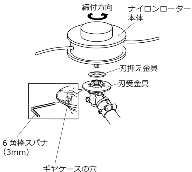
**■ 6角ボルトで締め付けるタイプ(例)**
