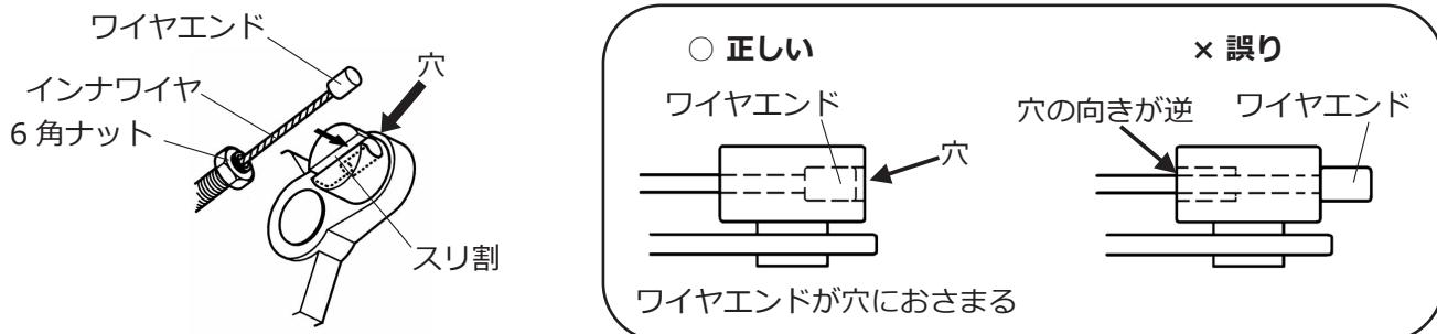
⑤ 2個の6角ナット(M6)でスロットルワイヤを右図のように仮止めしてください。
