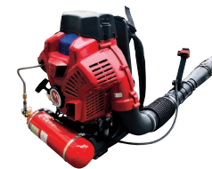
水素エンジンをを用いたブロワー試作機
