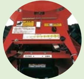
●バックルとRピンの脱着で簡単にタンク部を倒し、散布板・散布シッター部分の清掃がラクにできます。
