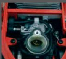
クリーンカバーを外すと簡単にキャブレターの取り外しができます。
