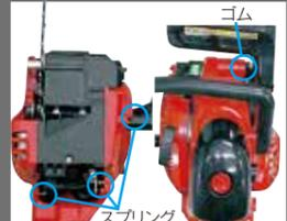
低周波振動を吸収するゴム防振と高周波振動を吸収するスプリング防振を組合せ、総合的な防振を確立しました。
