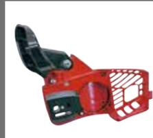
作業中、キックバックが起きた際、慣性力によってチェーンブレイキが作動し、0.1秒でソーチェーンの回転を強制停止します。
