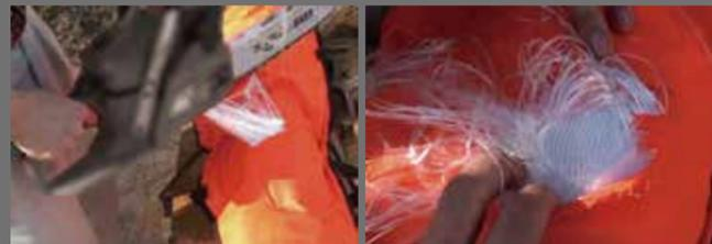
ソーチェーンが服に当たると、ラミネートされた繊維が引き出され、絡みつき、チェーンの回転を瞬時に停止させます！
