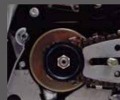
インボードクラッチなのでチェンが掛けやすく、ハンドガードが両側支持なので作動が確実です。
