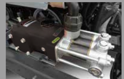
5連動噴&給水装置標準装備 5連動噴による給水装置を標準装備しました。
