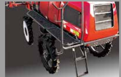
回廊フロア&後方乗降ステップ キャビン内に乗り降りしやすい様に後方に格納式のステップを装備しました。丸山オリジナル回廊フロアとの組み合わせで乗り降りしやすい作業の幅が広がります。
