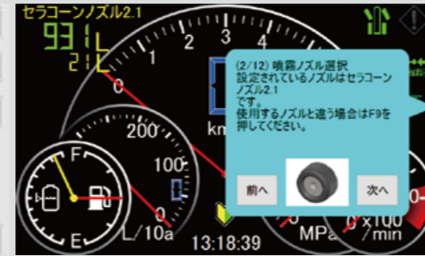
ノズル選択 選択したノズルの吐出量、使用圧力範囲なども画面選択で把握できます。
