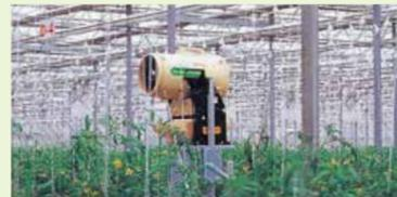
FCシステムは、噴頭部の送風により、一定時間空気を循環させてハウス全体に強制対流を作り出し、超微粒の薬剤を少量ずつハウス内に霧化して、ハウス内全体の薬剤粒子密度を上昇させる散布システム。作物が繁茂しても葉と葉のすき間に粒子が流れるため、葉の表裏への付着効果が高い優れたシステムです。
