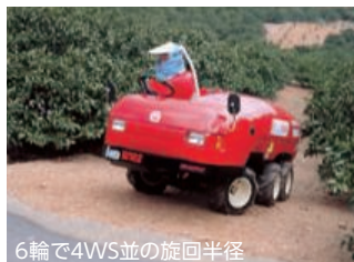
6輪で4WS並の旋回半径
