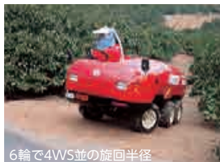
6輪で4WS並の旋回半径
