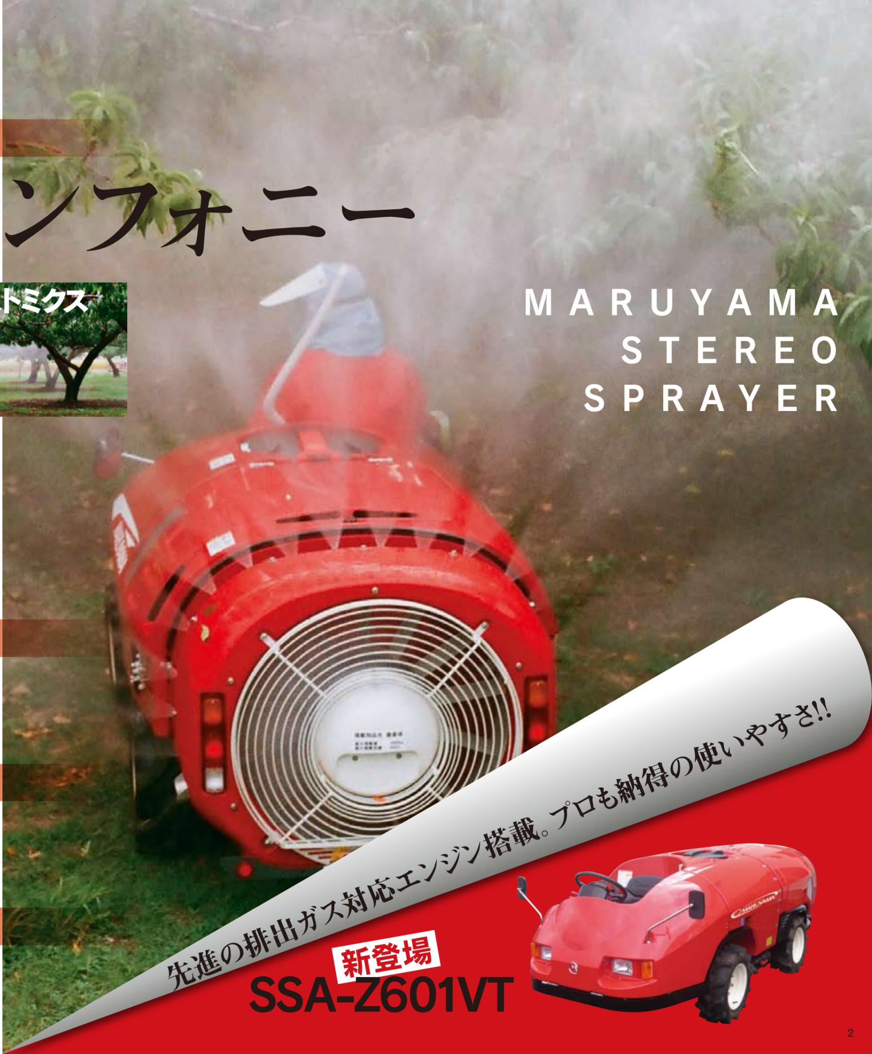
心臓部である動力噴霧機は定評のあるユニフロー(強制平弁式)SS専用動噴を搭載。圧力ロスを極力抑えた配管を行い果樹の仕立てにマッチした理想の噴霧状態を造ります。風洞各部の風速を点検しながら風量のバランスを調整します。これらの弛まざる 研究と知識から生まれた霧と風はひとつになり確かな足回りに支えられながら木々の葉の隅々まで広がります。
