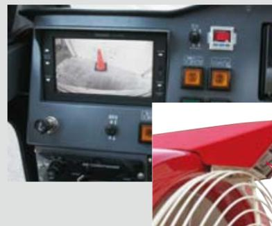
●カラーバックモニターを標準装備。バックギアと連動し、後進時に自動でレンズカバーが開き、モニターのスイッチが入ります。
