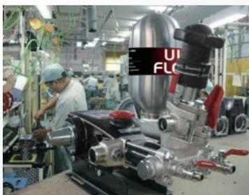
特殊ペレット入りでエア抜抑え、脈動・振動・騒音の発生を抑えます。長時間連続運転も安定して吐出できます。
