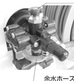
4. サキコックを「開」にします。圧カスイッチが作動し、ポンプが動き出します。
