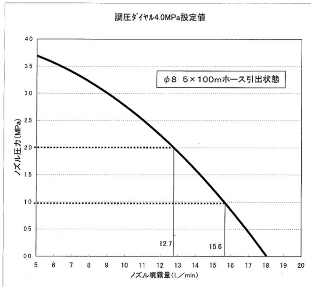
例えば、ノズル圧力2MPaとした場合、12.7 L/minが最大噴霧量ということになります。このグラフを参考にノズルを選定してください。
