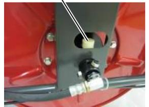
キャップを時計方向に回して、軸の周りからグリスがはみ出るまで給油します。グリスがなくなったらキャップを外して万能グリスを補充します。
