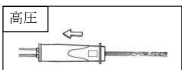
先端を手元に引くと、高圧になります。手前に押出すと、低圧に戻ります。低压モードは、高压洗浄で飛び散った汚れの仕上げ洗浄等に使います。
