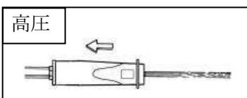
先端を手元に引くと、高圧になります。手前に押出すると、低圧に戻ります。低圧モードは、高圧洗浄で飛び散った汚れの仕上げ洗浄等に使います。
