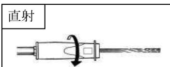
先端を矢印の方向に回すと、(直射)になります。剥離や樹木の皮剥ぎなど強い打力を必要とする時に使います。
