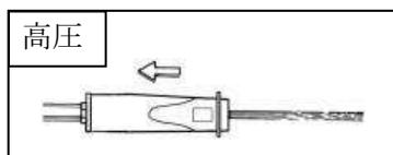
先端を手元に引くと、高圧になります。手前に押出すと、低圧に戻ります。
