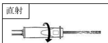
先端を矢印の方向に回すと、(直射)になります。剥離や樹木の皮剥ぎなど強い打力を必要とする時に使います。
