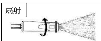
先端を矢印の方向に回すと、(扇射)になります。建設機械や農業機械の床洗浄や器材の洗浄時に使います。
