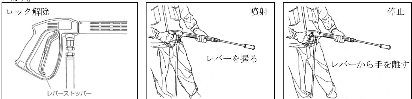
3. ガンノズルは、ノズルを前後に動かすことにより吐出圧を高圧・低圧に切り替えることができ、またそれぞれの圧力で、ノズルを回転させることにより噴流の形状を直射・扇形と無段階に調整できます。
