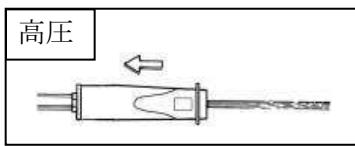
先端を手元に引くと、高圧になります。手前に押出すると、低圧に戻ります。低圧モードは、高圧洗浄で飛び散った汚れの仕上げ洗浄等に使います。
