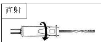
先端を矢印の方向に回すと、(直射)になります。剥離や樹木の皮剥ぎなど強い打力を必要とする時に使います。
