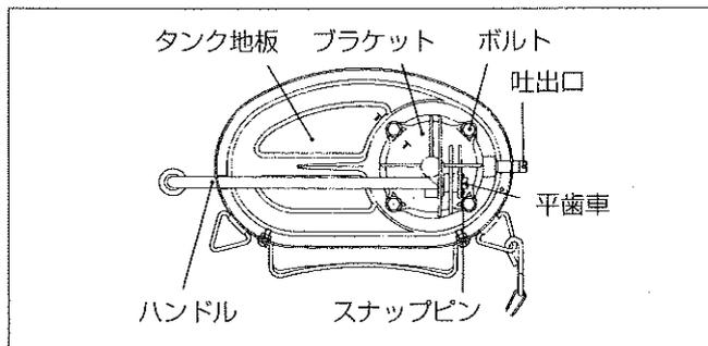
工場出荷時は、標準の体位に合わせてありますが、ハンドル位置を変えたい時には、スナップピンを抜き取り、平歯車の噛合をずらし適宜のハンドル位置に調整してください。
