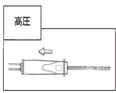
先端を手元に引くと、高圧になります。奥に押出すると、低圧に戻ります。低圧モードは、高圧洗浄で飛び散った汚れの仕上げ洗浄等に使います。
