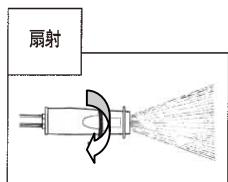
先端を時計方向に回すと、（扇射）になります。建設機械や農業機械の床洗浄や器材の洗浄時に使います。
