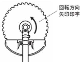
1. 刃受金具に六角棒スパナを差し込み、刃受金具を回らなくしてから刈刃取付用ナットを付属のコンビボックススパナで右に回してゆるめてください。刈刃取付用ナットと刃押え金具を取り外してください。
