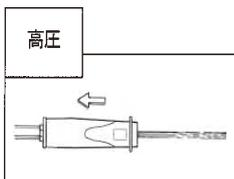
先端を手元に引くと、高圧になります。奥に押出すと、低圧に戻ります。低圧モードは、高圧洗浄で飛び散った汚れの仕上げ洗浄等に使います。
