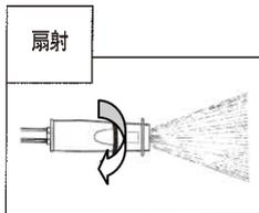
先端を時計方向に回すと、（扇射）になります。建設機械や農業機械の床洗浄や器材の洗浄時に使います。
