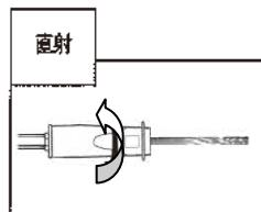
先端を反時計方向に回すと、（直射）になります。剥離や樹木の皮剥ぎなど強い打力を必要とする時に使います。洗浄物にノズルを近づければ、洗浄力が増すわけではありません。洗浄力が高くなるのは15～20cmの距離です。
