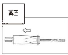
先端を手元に引くと、高圧になります。奥に押出すると、低圧に戻ります。低圧モードは、高圧洗浄で飛び散った汚れの仕上げ洗浄等に使います。
