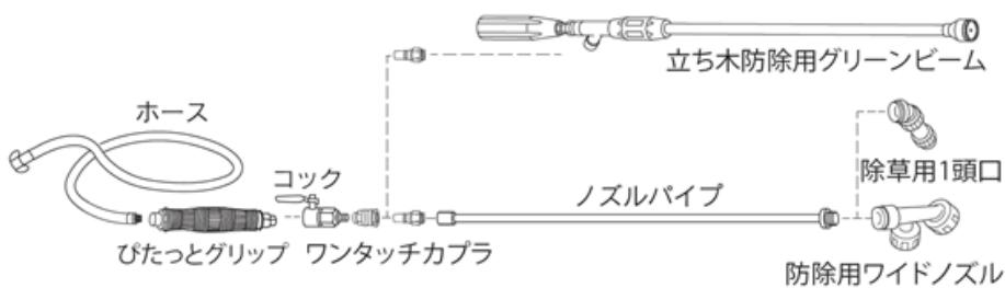
ノズル、ノズルパイプ、ボールコック、噴霧ホースの順で接続し、ホースの反対端は噴霧機の吐出口に接続します。
