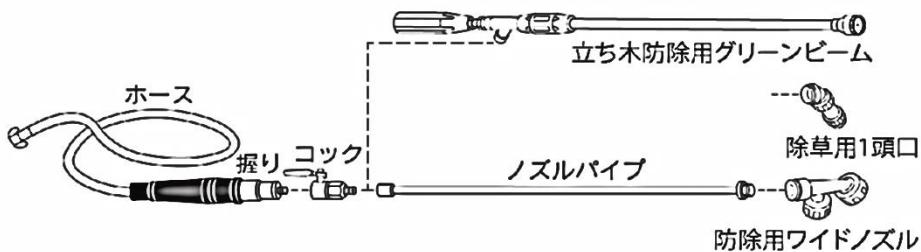
ノズル、ノズルパイプ、ボールコック、噴霧ホースの順で接続し、ホースの反対端は噴霧機の吐出口に接続します。
